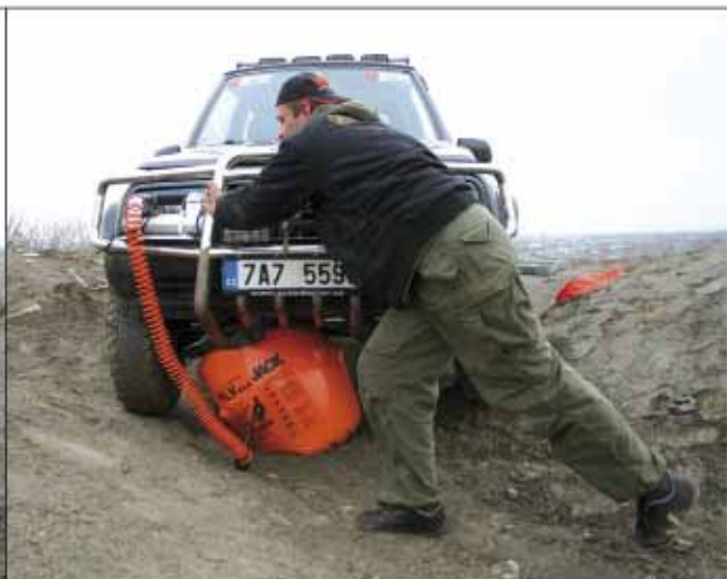
Dosažený rozdíl 20 cm při neúplném nafouknutí vaku
