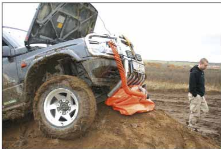
Šikmo uložený vak připojený na kompresor
